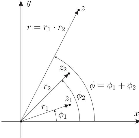
Рис. 3. Произведение комплексных чисел  $z = z_1 z_2$ .
